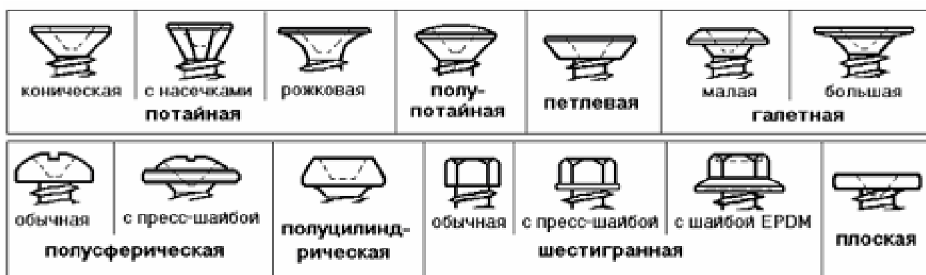
Рис.1. Типы головок шурупов и саморезов
